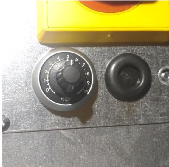
Le caisson est livré avec le potentiomètre réglé sur la position 5. Il est déconseillé de régler le potentiomètre entre les positions 0 et 2.
