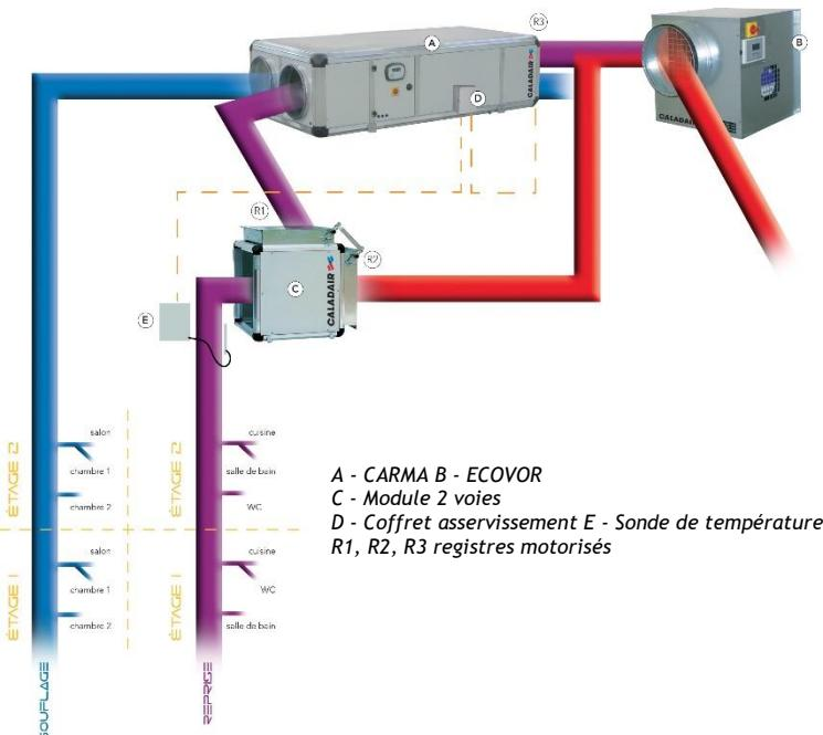
assurant l'extraction permanente de l'air vicié ou de désenfumage + 1 sonde de température à positionner en tête de chaque colonne (option) + 1 module 2 voies motorisé + 1 coffret d'asservissement (monté câblé sur la centrale).
